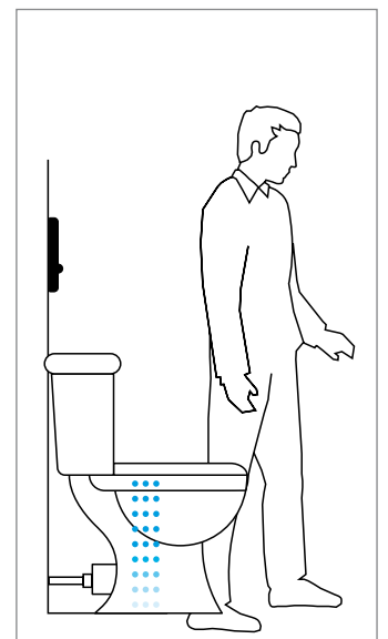
4 L'orinatoio entra in funzione quando la fotocellula rileva l'allontanamento della persona The urinal works when the sensor detects the person removal L'urinoir commence à fonctionner comme l'utilisateur s'éloigne El urinario empieza a funcionar en cuanto el usuario se aleja del sensor
